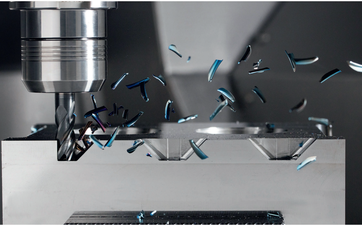
1 Der WNT-Tauchfräser MonsterMill PCR Uni von Ceratizit kann bohren, zentrieren und fräsen. Bei WVG alu-tec verkürzte er die Zeit für das Nutfräsen von 10 auf 1,5 min © Ceratizit
